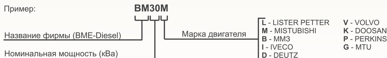
В нормативно-технической документации дизель-генераторы обозначаются в соответствии с ГОСТ 23162-78.
